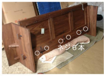
①ソファーを倒し、下部の くさび部分のネジを6本 外す
